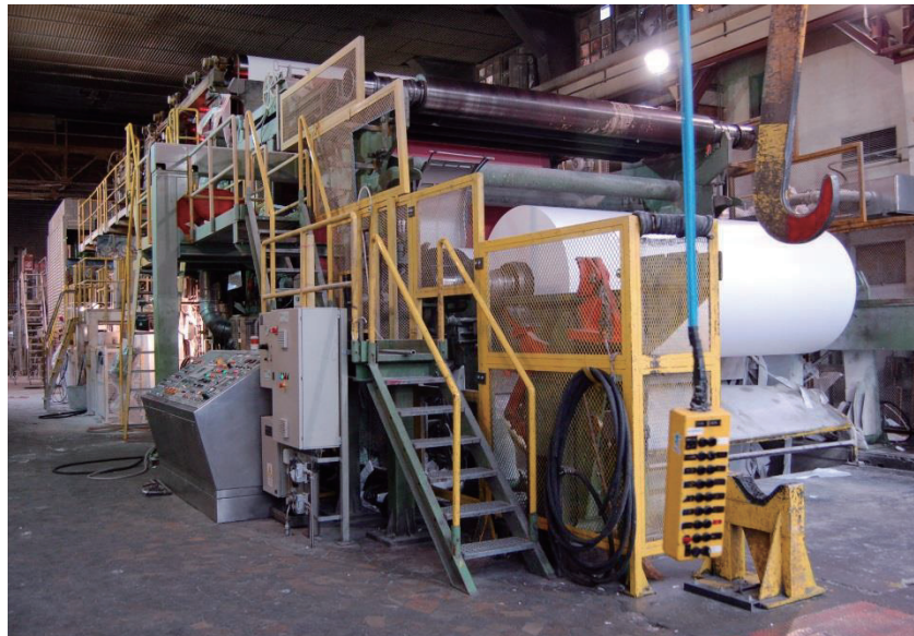
图1: 在纸加工线中, 纸浆从流浆箱流到筛分输送机上, 在那里辊快速将其压入到湿纸幅中。在湿压环节, 吸水毛毯辊挤掉液体, 固化纤维, 减少厚度。在干燥环节, 加热辊除去额外的水分。
