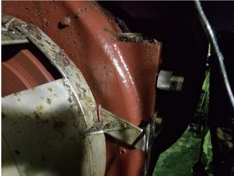
图4：吸水毛毯辊轴承套和已安装的传感器图片
